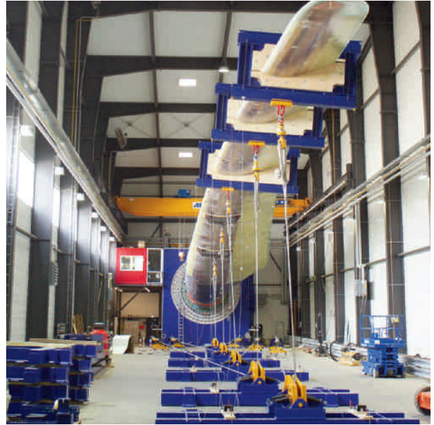
ローターブレードは実証試験の前段階で疲労耐久試験が実施され、運用においても光ファイバーの歪み計測システムを内部に設置して監視を行っています / 試験、監視計測システムはHBM提供 写真: フラウンホーファー、風力エネルギー&エネルギー・システム技術研究所
