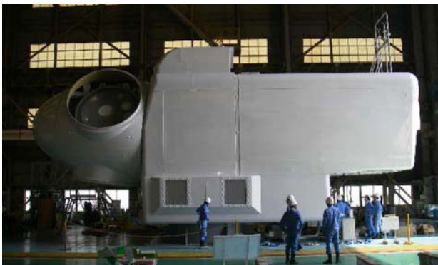
図 2.5 洋上風車のナセル (2.4MW)
