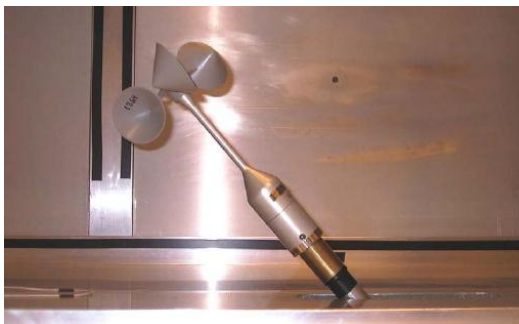
図4 カップ風速計の傾斜試験
