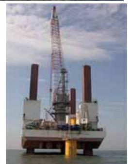
写真：工事に使用されている風車建設専用船「MPI Resolution」
