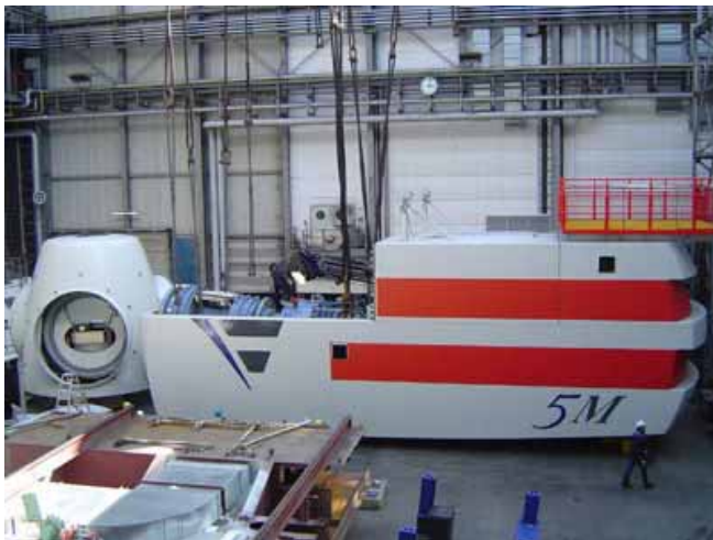
工場内で出荷を待つナセル。右下の人で大きさがわかる。長さ 18m、高さ 6m、幅 6m、重量 290 t。
