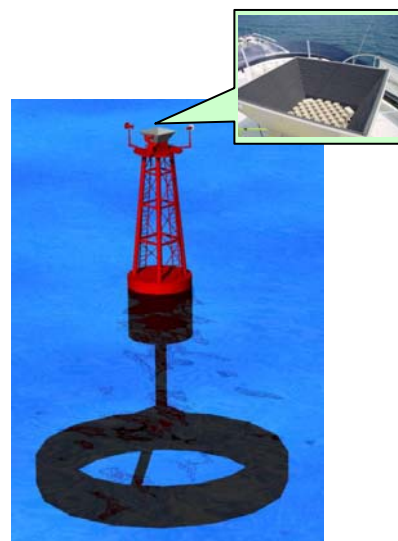
浮体式洋上風況観測システム イメージ
