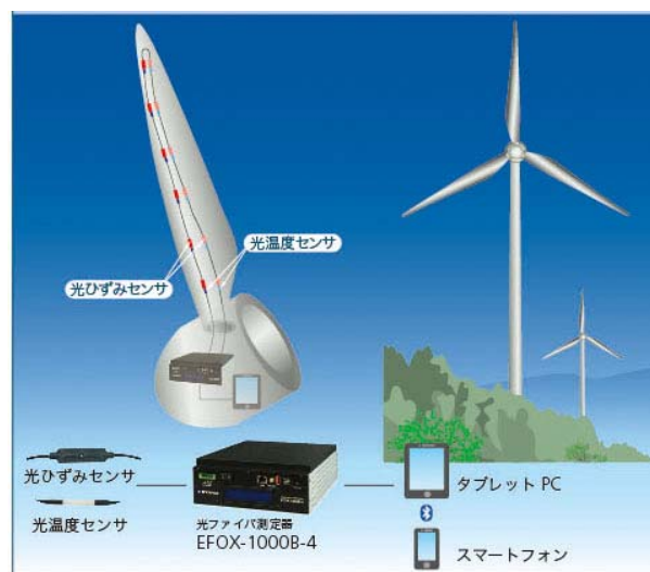
図2 光ファイバを用いたタービンブレードのひずみ測定例
