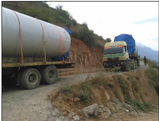
ブータンプロジェクトでの輸送状況。サイトへの搬入路では、トラックはスイッチバックで坂道を登った。
