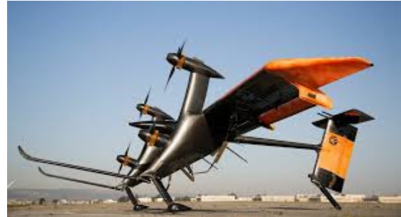
図3 Makani Power のグライダー型風車 4)
