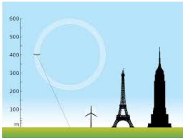
図1 空中風車の想定する稼働高度 1)
