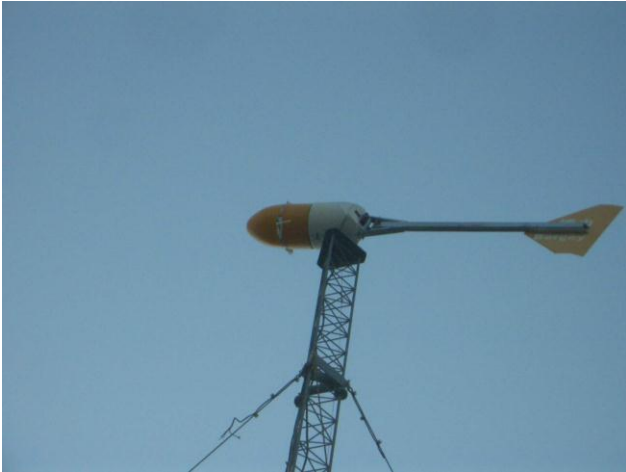
強風で羽根が吹き飛ばされた風車
