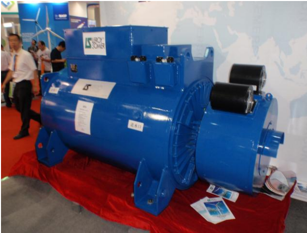
発電機（2 MW 用）
