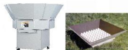
フェーズドアレー型ソーダー (左: ソニック、右: 英弘精機)
