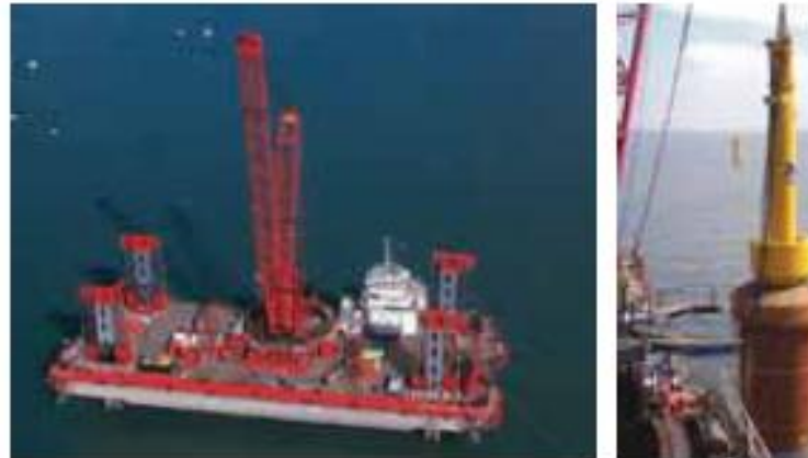
SEP(JUMPING JACK)によるモノパイルタワーの打設 出典: A2SEA HP
