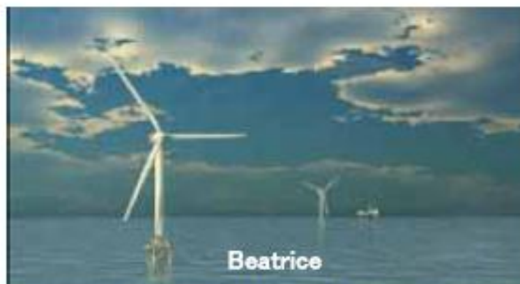
国名:イギリス、発電設備:10MW(5MW×2基)、基礎構造:ジャケット式、水深:45m、離岸距離:25km、運開年月:2006.9(出典:Beatrice HP)
