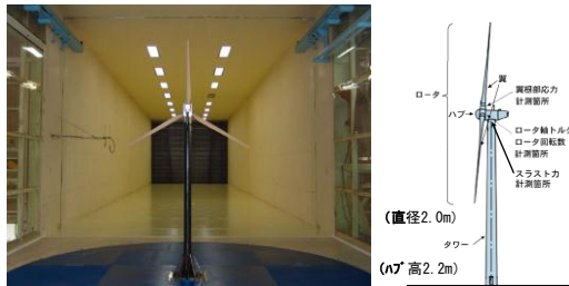
図 3-5 模型風車による風洞実験
